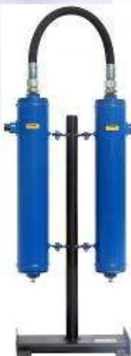
Фильтрационный модуль предназначен для тонкой очистки сжатого воздуха и различных газов от аэрозолей масла и влаги, а также от твердых частиц размером менее 1 мкм. Обеспечиваемое остаточное содержание аэрозоля масла - менее 0,1мг/м<sup>3</sup>. Используется в системах пневмоуправления и автоматики, пневмоприводе устройств и инструмента для окраски поверхностей распылением.
